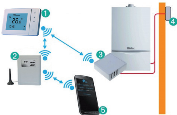
1-programovatelný termostat, 2-GSM EXEO Komunikátor, 3-Kotel s jednotkami VR34+EKV2020 , 4-Venkovní čidlo
