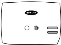
Ohřívač je zapnutý. Ohřev je velmi snížen, napětí nižší než 202V./ Ohrievač je zapnutý. Ohrev je veľmi znížený, napätie nižšie ako 202V / The heater is on. The heating is very limited, voltage below 202V./ Der Erhitzer ist eingeschaltet. Die Erhitzung ist stark reduziert, Spannung unter 202V
