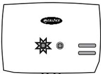
Ohřívač je zapnutý. Ohřev je snížen, napětí nižší než 218V./ Ohrievač je zapnutý. Ohrev je znížený, napätie nižšie ako 218V. / The heater is on. The heating is limited, voltage below 218V./ Der Erhitzer ist eingeschaltet. Die Erhitzung ist reduziert, Spannung unter 218V
