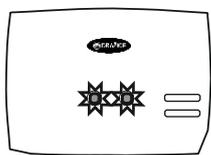
Ohřívač nehřeje. Zapnutá aktivní ochrana přehřátí spirály. Napětí nižší než 218V./ Ohrievač nehřeje. Zapnutá aktívna ochrana prehriatia špirály. Napätie nižšie ako 218V./ The heater does not heat. Switched active protection of the spiral overheating. Voltage below 218V./ Der Erhitzer heizt nicht. Der Aktivschutz der Überhitzung der Heizspirale ist eingeschaltet Die Spannung ist niedriger als 218V
