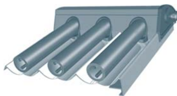
Řez vakuovým kolektorem
